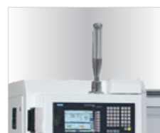
Spia luminosa · Mostra in modo ottico lo stato macchina
