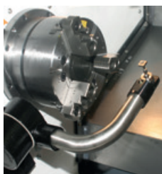
Tastatore per misurazione utensile · Tastatore Renishaw consente la misurazione degli utensili all'interno della macchina
