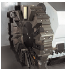
Sistema di cambio utensili · 12 posizioni dell'utensile · Torretta portautensili idraulica (LS 200) · Altezza max attacco 25 mm · Diametro attacco 32 mm
