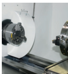
Autocentrante idraulico a tre griffe Ø 200 mm · Facile serraggio dei pezzi di lavorazione · Passaggio Ø 52 mm
