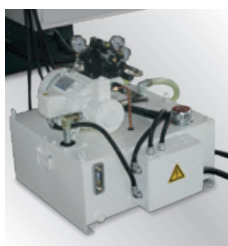
Centralina idraulica · Per ganasce di serraggio, mandrini per tornio e torretta portautensili · Potenza motore 750 W · Capacità serbatoio 50 litri · Pressione di serraggio / pressione di esercizio 2.500 - 2.942 kPa
