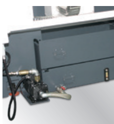
Serbatoio del refrigerante · Vaschetta portatrucioli estraibile · Serbatoio del liquido lubrificante estraibile · Spia indicatrice di livello · Portata serbatoio 99 litri
