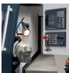
Autocentrante idraulico a tre griffe Ø 200 mm · Passaggio Ø 52 mm · Facilità di serraggio dei pezzi
