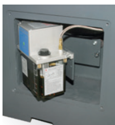
Sistema di lubrificazione centralizzato · Automatico · Apribile per un facile riempimento del serbatoio · Lubrificazione automatica della testa portamandrino · Lubrificazione automatica delle slitte longitudinali e trasversali
