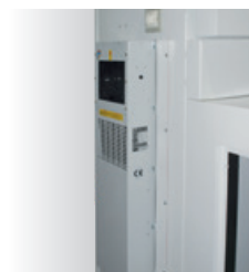
Scambiatore di calore · Integrato nel quadro comandi · Efficiente trasferimento del calore · Impedisce che si verifichino guasti causati dal surriscaldamento dei componenti elettronici e CNC
