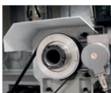
Mandrino · Encoder incrementale per il posizionamento del mandrino (filettatura) · Ampio foro mandrino
