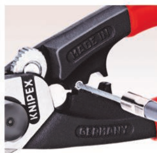
Crimpaggio del terminale sulla fune metallica
