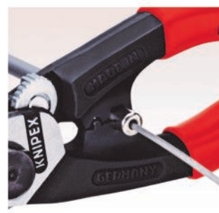
Crimpaggio del terminale sulla guaina esterna del cavo Bowden
