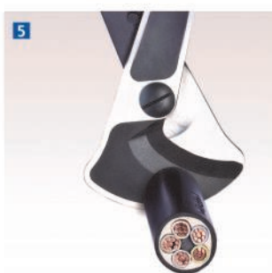
Ripetere l'operazione di taglio e apertura fino alla conclusione del taglio
