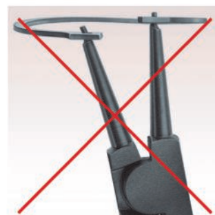
Comune pinza per anelli di sicurezza: possibile deformazione dell'anello durante il montaggio
