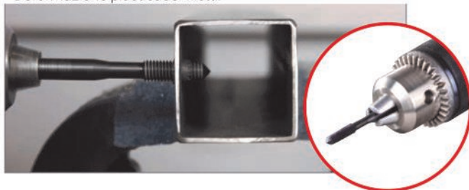
Deformazione plasticadei filetti:
