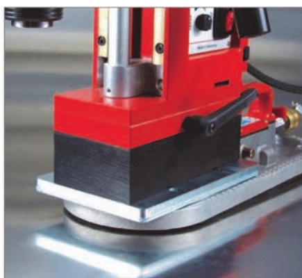
Piastra di serraggio sottovuoto con attacco aria compressa per trapani a cavalletto magnetico adatta a tutte le superfici non magnetiche.
