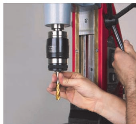
Maschio a macchina: rotazione destrorsa/sinistrorsa per filettature fino a M 30
